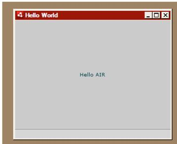
使用 `Label` 控制項的 `horizontalCenter` 和 `verticalCenter` 屬性，將文字放置在視窗的中央。移動或調整視窗大小的方式，與其他任何桌面應用程式相同。
