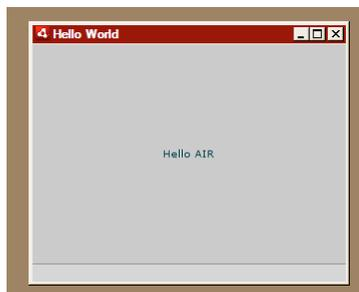
Grâce aux propriétés horizontalCenter et verticalCenter du contrôle Label, le texte est placé au centre de la fenêtre. Vous pouvez déplacer ou redimensionner la fenêtre comme pour toute autre application de bureau.
