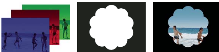
Canali colore separati Rosso, Verde e Blu (a sinistra); il canale alfa o maschera (al centro) e i tutti i canali visualizzati contemporaneamente (a destra)
