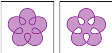
Tracé se croisant à plusieurs reprises utilisant la règle de remplissage extérieur/intérieur non nul (gauche), par opposition à la règle de remplissage pair/impair (droite)
