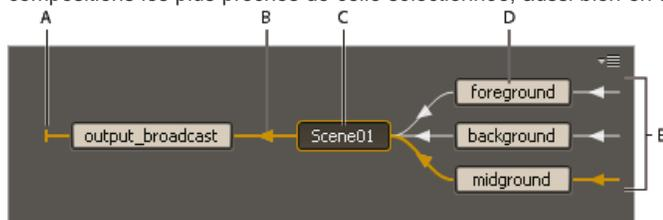
**A.** Indicateur signalant qu'il n'existe aucun flux en sortie pour la composition **B.** Sens du flux **C.** Composition active (courante) **D.** Compositions en amont **E.** Indicateur signalant qu'il n'existe un flux en entrée pour la composition
