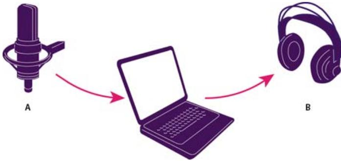
**A.** Las entradas de la tarjeta de sonido se conectan a fuentes como micrófonos y platinas. **B.** Las salidas de la tarjeta de sonido se conectan con altavoces y auriculares.
