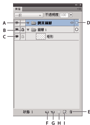
A. 擴張 / 隱藏圖層 B. 鎖定 / 解除鎖定圖層 C. 顯示 / 隱藏圖層 D. 作用中圖層 E. 刪除圖層 F. 新增 / 重製圖層 G. 新增子圖層 H. 增加遮色片 I. 新增點陣圖影像
