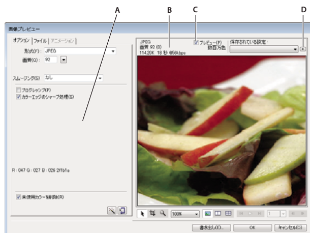
A. 選択された書き出しの保存されたオプション B. 推定されるファイルサイズとダウンロード時間 C. 選択した書き出し設定の結果をプレビュー D. アクティブな表示の書き出し設定を保存
