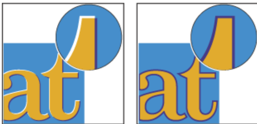
未应用陷印时的套印错误（左）和应用陷印后的效果（右）
