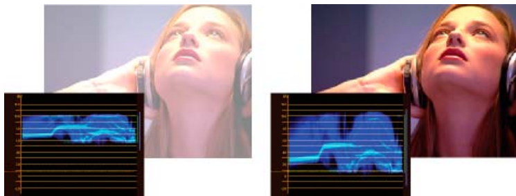
露光量の補正：波形が IRE スケールの上限になっている露出過度の画像（左）、波形が 7.5 ～ 100 IRE の範囲内になっている補正後の画像（右）
