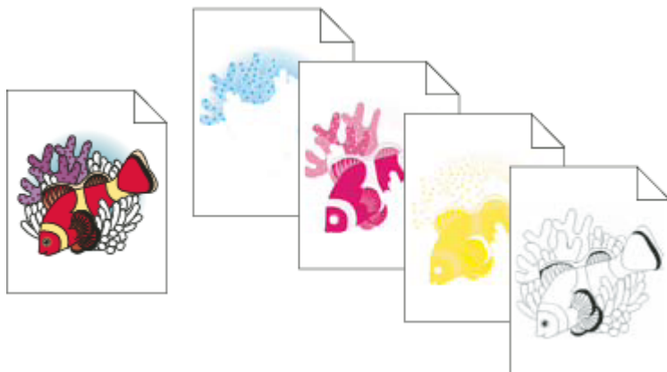
Színes lézernyomtatón nyomtatott kompozit kép összehasonlítása egy levilágítóval létrehozott négy színre bontással.
